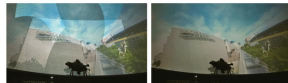
輝度補正：輝度ムラからスクリーンの汚れ・目地まで補正
